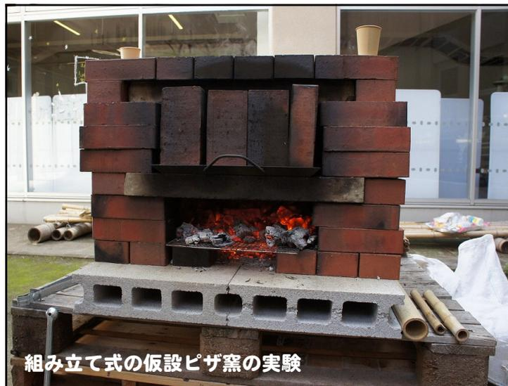
組み立て式の仮設ピザ窯の実験
