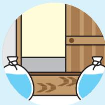
水のうと長めの板などを組み合わせて利用し、浸水を防ぎます。
